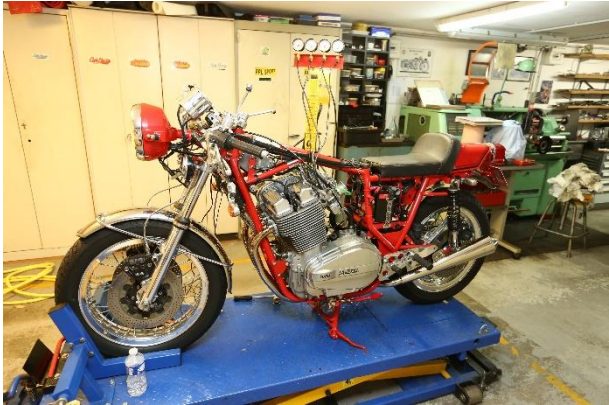
Mise en place du réservoir auxiliaire et des dépressiomètres.
