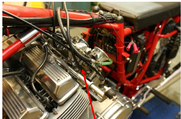
Détail du raccordement du tube de dépressiomètre sur le corps du carburateur cylindre N°1
