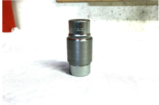
Douille rallongée pour écrou de 36, côté droit vilebrequin
