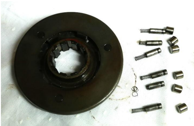
Roue libre avec galets, poussoirs et ressorts abîmés
