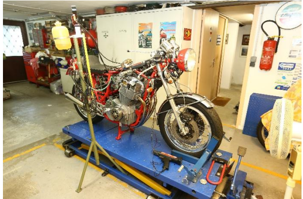
Vue du porte dépressiomètres, du réservoir auxiliaire, de la lampe stroboscopique à déphasage pour le calage de l'avance à l'allumage ( 9^\circ ), du ventilateur pour refroidir le moteur lors de la synchronisation des 3 carburateurs.
