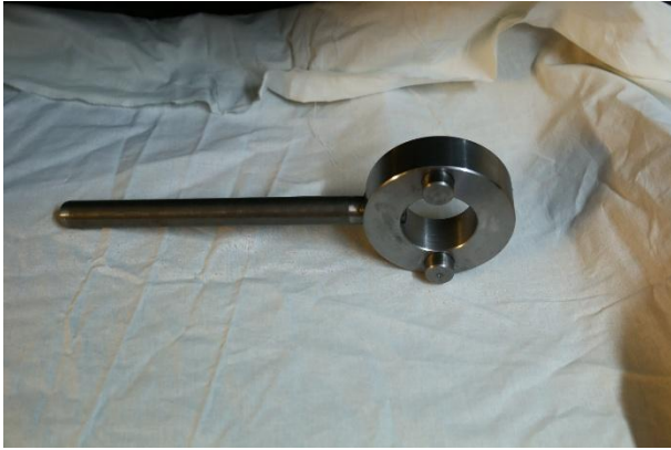
Outillage de blocage volant alternateur.
