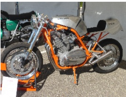
La belle Motodd Mk1 de Laurent. Freins Beringer, fourche Paioli, Amortisseur Ohlins. Elle est en cours de reconstruction.
