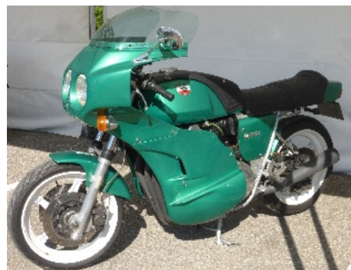
En y regardant de près, on remarque que la 3 cylindres de Gérard est équipée d'une injection maison, d'un mono-amortisseur type cantilever maison également, de roues spéciales...
