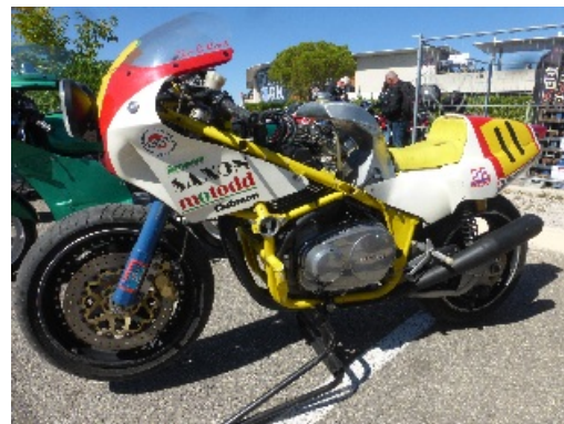
Motodd Mk5 ex Alan Cathcart. Cadre Cr Mo, fourche type Para lever (avant BMW), carbus de 40, 164 kg pour 106 cv à la roue.
